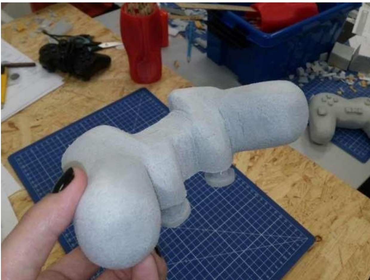
Рис. 7. Макет джойстика – геймпада.
